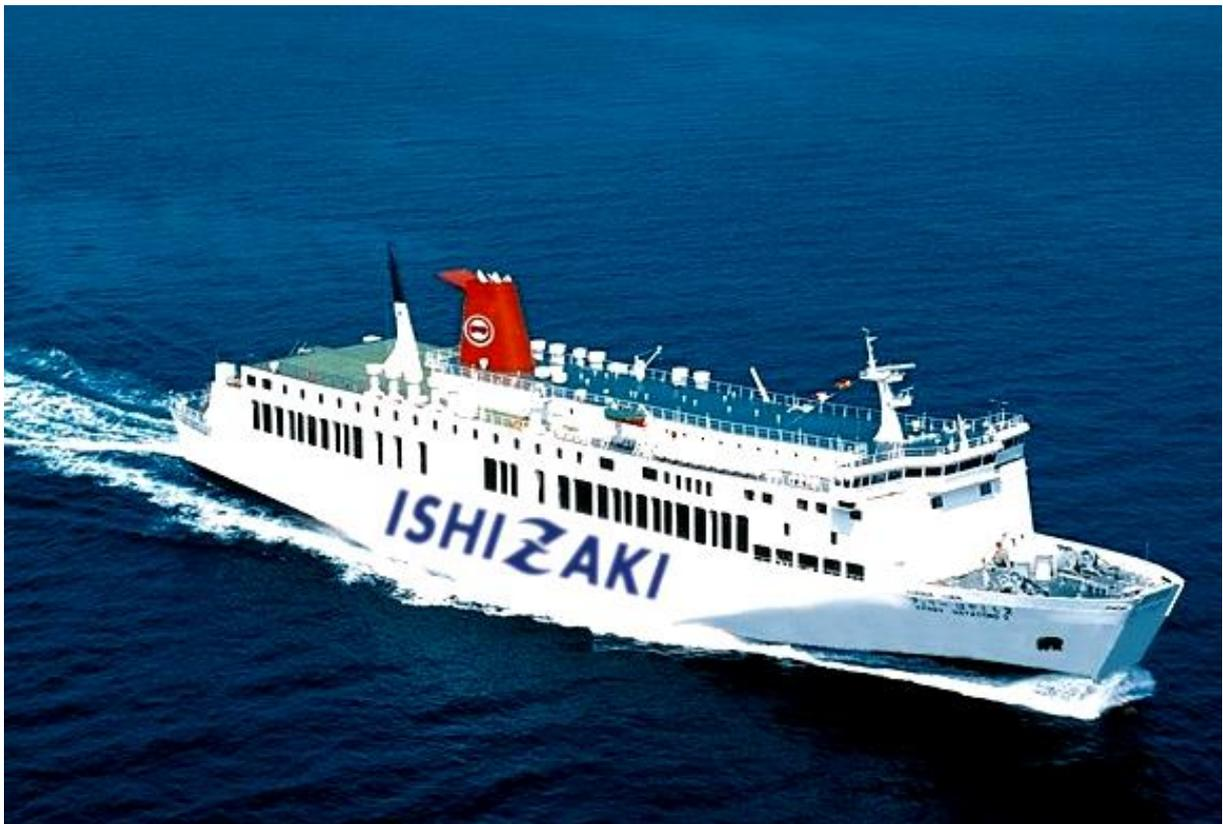
【船舶の概要】 ■総トン数：約 4,200 トン ■全長：119m ■全幅：21m ■旅客定員：約 500 人
